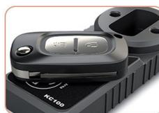
Emplacement pour détection de fréquence
